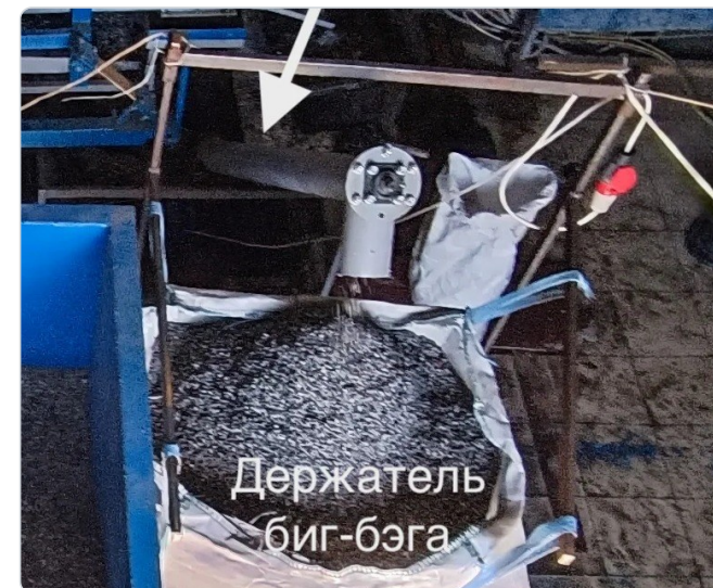
Фрагмент фото линии: биг-бэг на раме-держателе, над ним — узел, подписанный «бункер и шнек для забора пластика».
