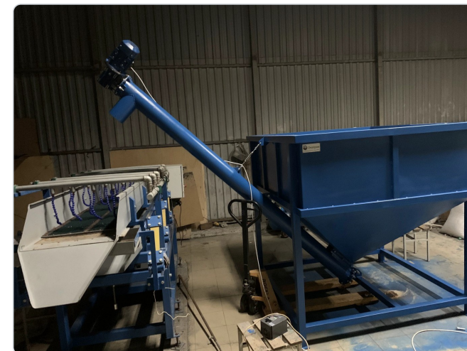
Синий бункер и наклонная труба со шнеком (фото с карточки этого узла на okoprom.ru).
