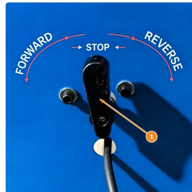
1 — рычаг. FORWARD — вперёд (работа), STOP — стоп, REVERSE — назад (вывести застрявший кабель).
