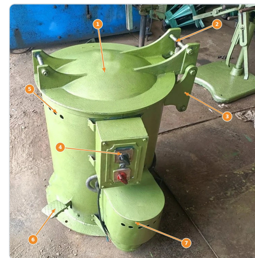
1 — крышка 2 — винт с пружиной 3 — кронштейн петли 4 — пост управления 5 — отверстия в стенке 6 — педаль (назначение не подтверждено) 7 — кожух привода
