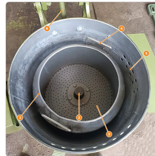
1 — стенка корзины 2 — ступица 3 — перфорированное дно 4 — ручка корзины 5 — отверстия в корпусе (назначение не установлено) 6 — винт у крышки (назначение не подтверждено)
