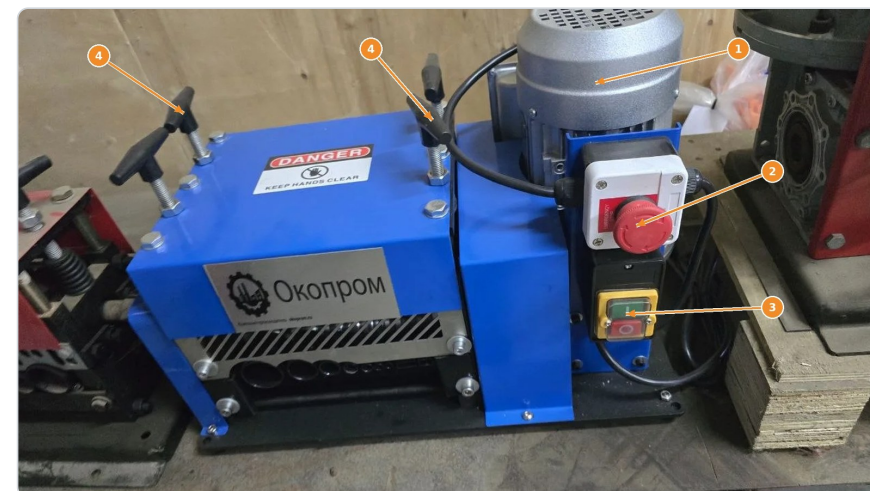
1 — двигатель 2 — аварийный стоп 3 — пуск / стоп 4 — Т-рукоятки
