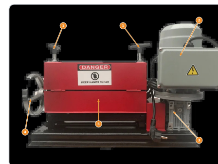
1 — рукоятки регулировки 2 — двигатель 3 — редуктор 4 — маховик 5 — корпус
